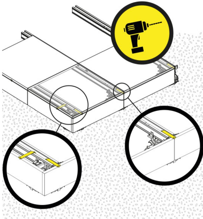
Bei Bedarf können die Platten am Rand der Terrasse mithilfe des Plattensoppers arretiert werden (s. nebenstehendes Schema).
