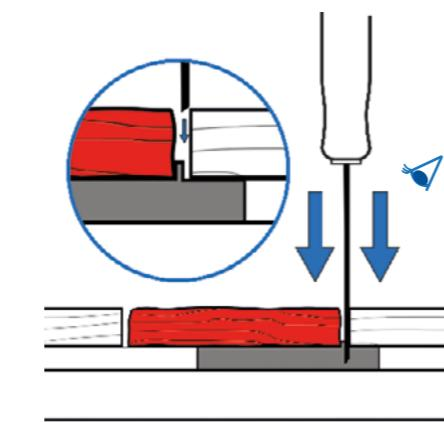
**2** Suchen Sie die Befestigungen mit einem Endstopper unter der defekten Dielle.
