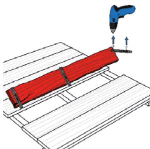
**4** Brechen Sie die entfernten Befestigungen von Hand auf und bewahren Sie nur die zackenförmigen Teile auf.
