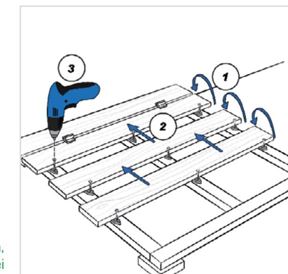
① Die Dielen können auch eine nach der anderen vorbereitet werden, dabei ist darauf zu achten, dass die Position der Befestigungen bei jeder Dielle jeweils versetzt auf der rechten und linken Seite der Mittelachse des Spannbalkens angeordnet wird.
