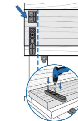
**7** Platzieren Sie die Stopper auf dem Spannbalken, ordnen Sie dabei die Position der einzelnen Stopper versetzt an, wie in der Zeichnung dargestellt (eine Stopperbreite als Abstand lassen). Diese nehmen die Stopper auf, die mit der neuen Dielle verschraubt werden. Verschrauben.
