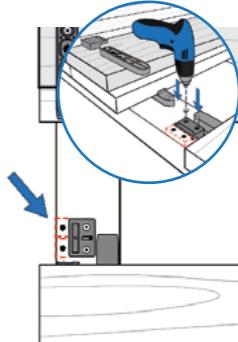
**8** **9** Drehen Sie die Dielle um und lassen Sie diese in ihre endgültige Position gleiten. Es werden eine oder zwei Schrauben benötigt, um die Dielle zu fixieren.
