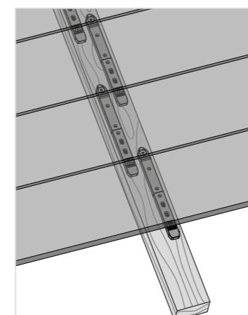
Überblick der Befestigungen unter den Dielen bei einer Verlegung ohne Dielenanschluss.
