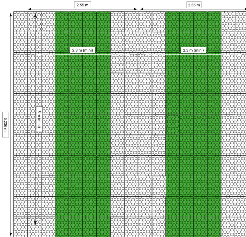
Selon la norme NF P91-100, les dimensions minimum d'une place de parking sont 2.3 x 5 m.
