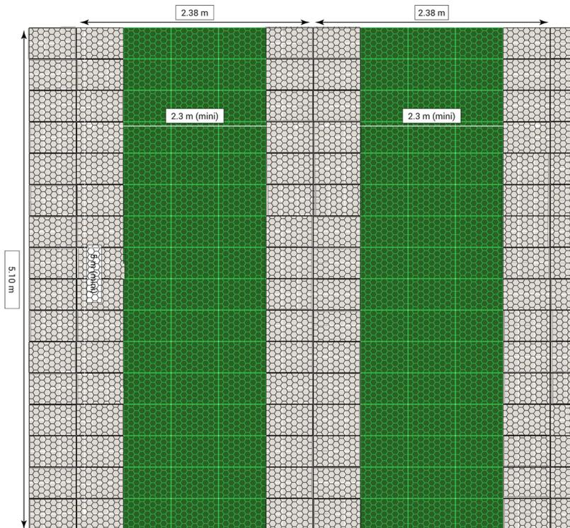
Selon la norme NF P91-100, les dimensions minimum d'une place de parking sont 2.3 x 5 m.
