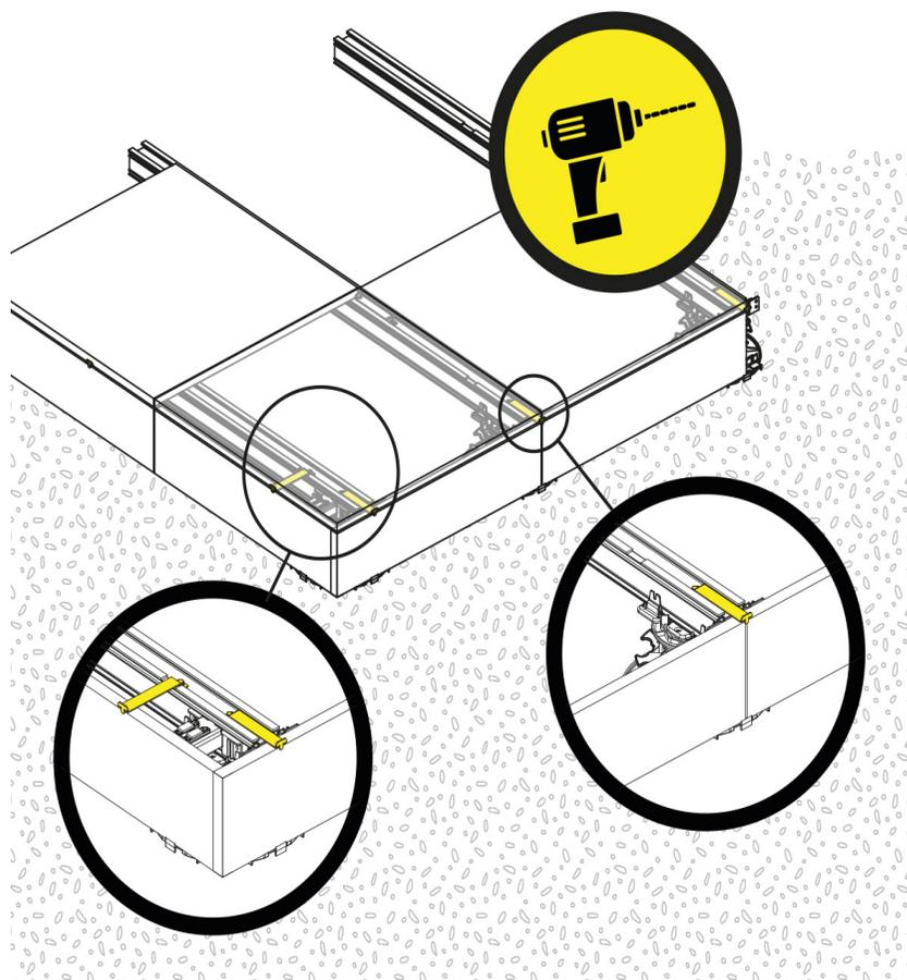
Si besoin, les dalles en bord de terrasse peuvent être maintenues à l'aide de l'arrêt de dalle (voir schéma ci-contre).
