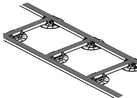
\* Etréssillon : pièce placée entre les lambourdes de la structure pour la consolider.
