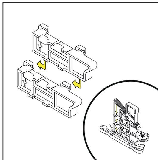
Assembler les pièces avant de les positionner sur le plot
